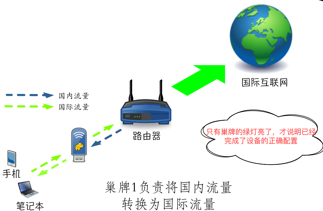
巢牌无线软路由工作原理图
